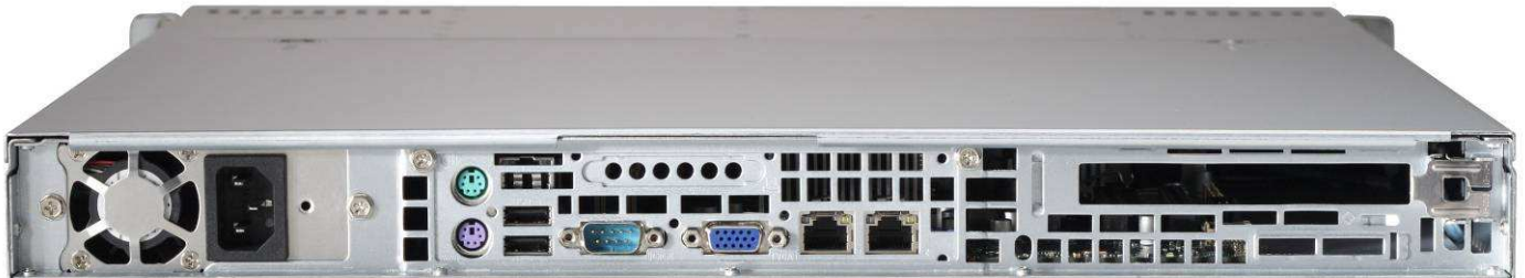
Châssis rack 1u alimentation 350W
